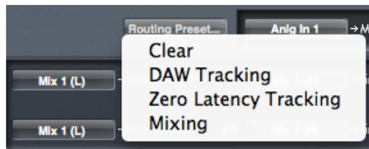
Scarlett MixControl permite una gran flexibilidad en las posibilidades de enrutamiento. Para ayudarlo a realizar sus configuraciones de enrutamiento y mezcla, son proporcionados los presets (configuraciones preestablecidas) de enrutamiento. La utilización de presets permite configurar rápidamente el enrutamiento para grabación (monitorizar sus entradas) y mezcla (enviando señales fuera de la interfaz hacia procesadores externos o hacia una consola externa).
