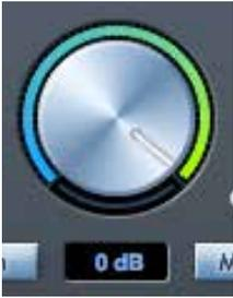
Ajuste el nivel de salida de todas las salidas seleccionados con este control, usando el mouse. La pantalla numérica muestra el nivel de salida de monitorización actual.
