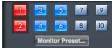
Estos botones seleccionan cual de las salidas de línea de Scarlett 18i20 se verán afectadas por los otros controles de la sección de monitorización GUI y también por los controles de monitorización del panel frontal. Dependiendo de su configuración, usted puede monitorizar sin altavoces, sólo con un altavoz, o con hasta 10 altavoces de forma simultánea.
