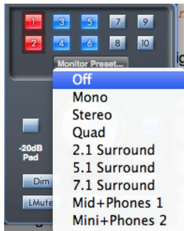
En esta sección se proporciona una gama de presets de configuraciones de monitorización. Haga clic en el botón **Monitor Preset...** para abrir una lista desplegable. Estos presets permiten una sencilla selección de configuraciones de monitorización comunes. Para que los presets de monitorización funcionen correctamente, debe tener los altavoces conectados a las salidas de línea tal como se muestra en la tabla de la página 17.
